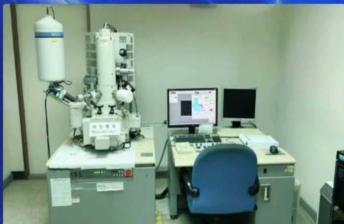
場發射掃描式電子顯微鏡
