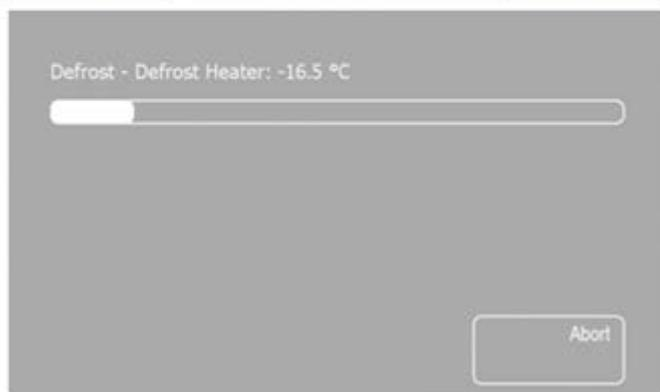
7. 除霜螢幕將出現，顯示除霜進度和蒸發器的實際溫度。
